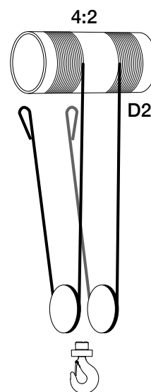
D2 - 4 TIRI DI FUNE (4/2) TIRO CENTRALE D2 - 4 ROPE FALLS (4/2) TRUE VERTICAL LIFT
